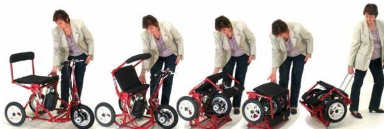
Pliage automatique sur simple pression d'un bouton sur le scooter
